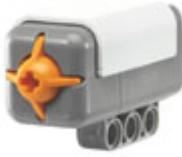
Der Tastsensor wird analog betrieben. Dieser passive Sensor hat eine sehr geringe Stromaufnahme.
